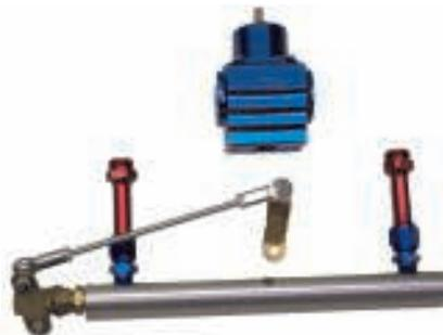
**DUAL PRESSURE BYPASS FOR METHANOL**
